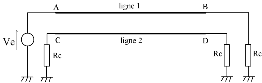
Figure 54 : lignes chargées par leur impédance caractéristique
